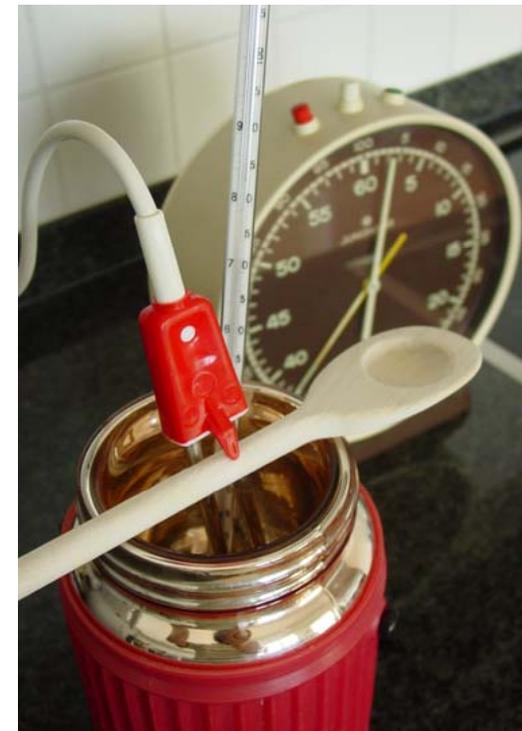
Ricordiamo che la relazione tra **il tasso di trasferimento di energia** ( $\mathcal{P}_{el}$ ) dal riscaldatore ad immersione all'acqua e **l'intensità della corrente di entropia** ( $I_S$ ) che entra nel sistema “acqua” è data da:
