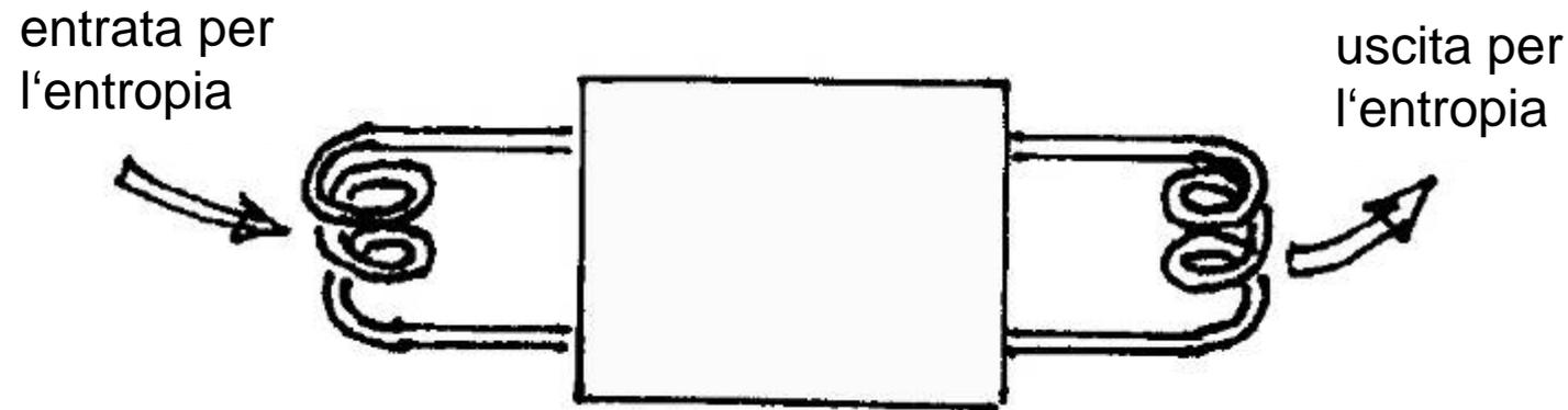
Una pompa di calore fa fluire entropia da punti a temperatura bassa verso punti a temperatura più alta.
