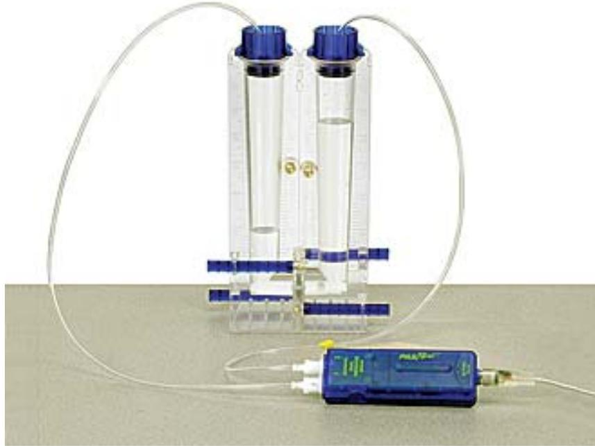
**Figura 5.9.** Osmometro prodotto dalla ditta Pasco. La variazione di pressione dovuta alla diffusione dell'acqua attraverso una membrana semipermeabile viene direttamente misurata da un apposito sensore.
