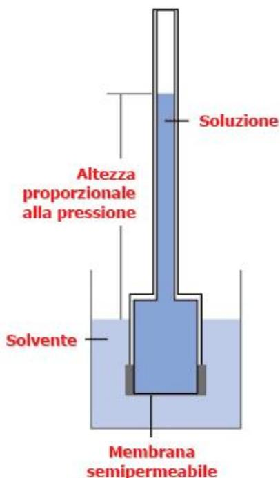
**Figura 5.8.** Osmometro “classico”. La misura dell’altezza della colonna di liquido al di sopra della membrana semipermeabile permette di determinare la differenza di pressione che si genera tra i due lati della membrana (vedi legge di Stevino 3.3). La differenza di pressione è direttamente proporzionale alla differenza di potenziale chimico dell’acqua, che si trova ai due lati della membrana.
