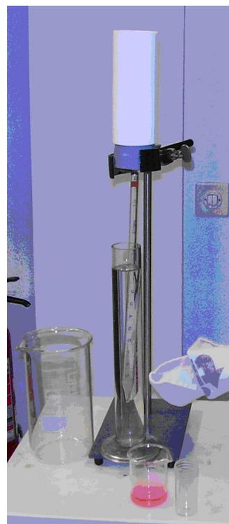
**Figura 5.3.** Apparecchiatura per lo studio della diffusione di un gas.
