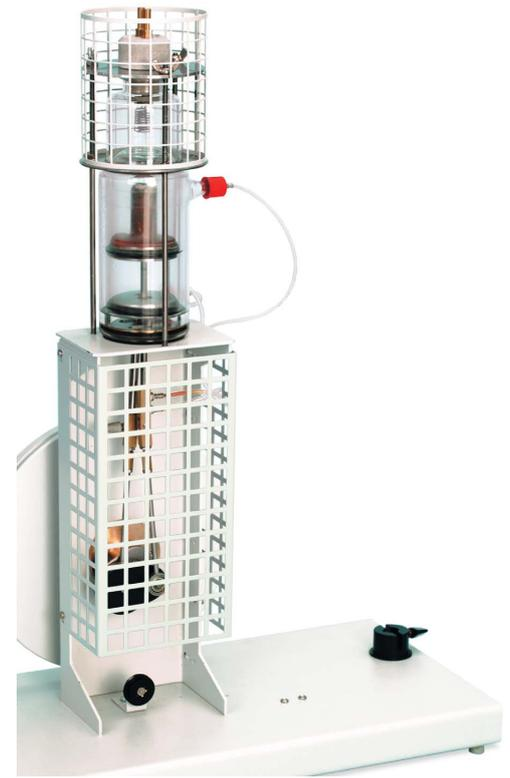
Fig. (5.7): Motore Stirling.
