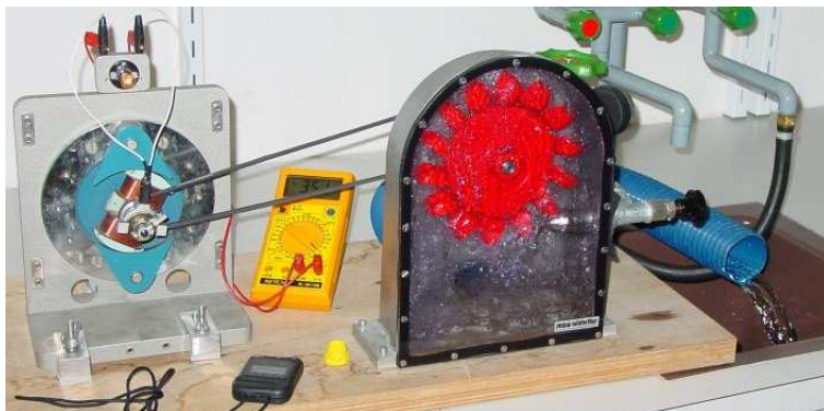
Figura 2.15: Dalla turbina alla lampadina: una turbina idraulica viene impiegata per far funzionare una dinamo che a sua volta alimenta una lampadina ad incandescenza.
