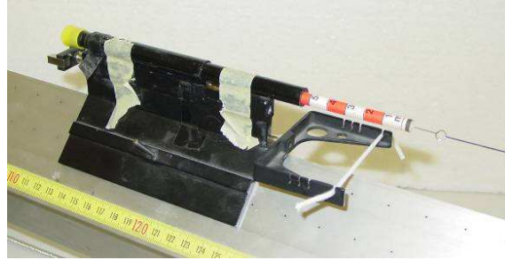
Figura 2.20: Trasferimento di quantità di moto: una slitta, che può muoversi (praticamente) senza attrito su di un binario a cuscino d'aria, viene messa in moto con una forza costante. La sua quantità di moto aumenta linearmente in funzione del tempo. Il dinamometro fissato sulla slitta permette di conoscere il valore della forza agente. Separatamente viene misurata la velocità in funzione del tempo.
