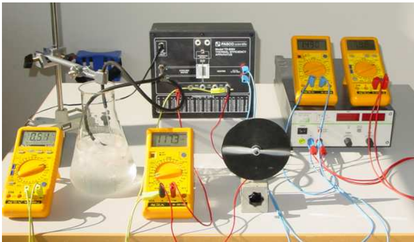
Figura 3.19: Determinazione sperimentale del rendimento e dell'efficienza di un termogeneratore: l'apparecchiatura permette la determinazione sperimentale del rendimento e dell'efficienza del dispositivo. Come carico esterno è impiegato un piccolo motore elettrico.
