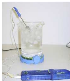
Figura 3.28: Transizione di fase acqua – ghiaccio: per mantenere il più possibile uniforme la temperatura del sistema, il bicchiere è posto su di un agitatore magnetico. La temperatura è registrata attraverso un sensore di temperatura on-line.
