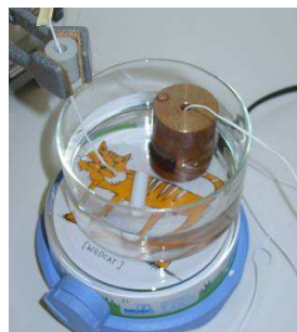
Figura 2.5: Contatto termico: un pezzo di rame riscaldato viene immerso a un certo istante in una bacinella contenente acqua alla temperatura ambiente. Con due sonde termometriche viene registrato l'andamento della temperatura per i due oggetti in funzione del tempo: man mano che il tempo passa, la differenza di temperatura si riduce, fino ad annullarsi. Il sistema raggiunge una situazione di equilibrio.
