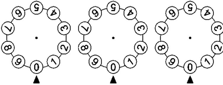
Per illustrare il collegamento meccanico tra le ruote proponiamo l'addizione  $4+6$ . La rappresentazione di 4 unità si ottiene agendo sulla prima ruota a destra e facendola scattare di quattro posizioni in senso orario:
