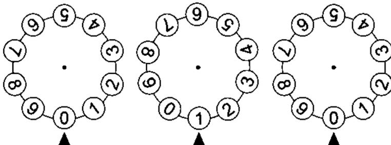
ruotando di una posizione in senso antiorario la prima ruota a destra (quella delle unità), dunque sottraendo un'unità, tale ruota si posiziona sul 9 e contemporaneamente il collegamento meccanico tra le due ruote fa muovere di una posizione in senso antiorario la ruota delle decine:
