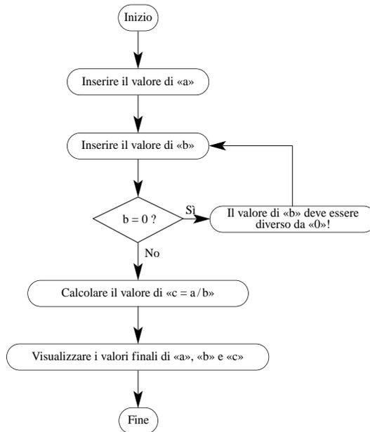
Figura 4 Esempio di un semplice diagramma di flusso che impedisce la divisione per zero di un numero.
