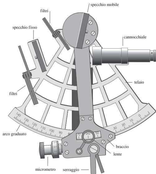
Esso permette di misurare con estrema precisione l'angolo sotteso tra due punti. Vediamo passo passo come muoverci sul terreno.
