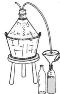
In un sistema di vasi comunicanti l'acqua tende a disporsi allo stesso livello
