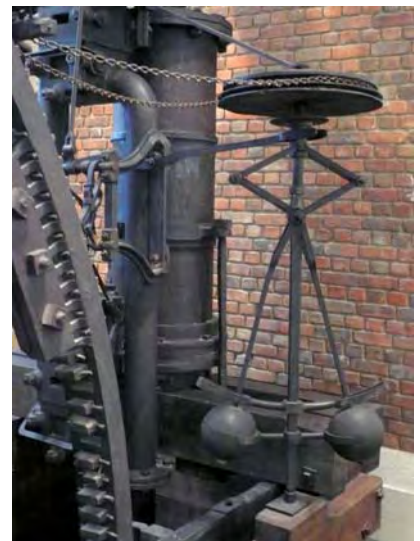
La macchina di Boulton e Watt del 1788 che serviva a mantenere costante la velocità di una macchina a vapore.
