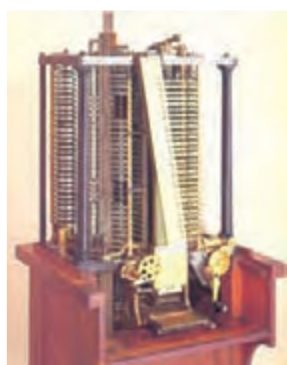
Fig. 6 Una porzione dell'organo di calcolo ( mill ) della Macchina Analitica, fatta costruire da Henry Prevost Babbage nel 1910. L'organo di stampa si trova al di sotto della struttura obliqua.
