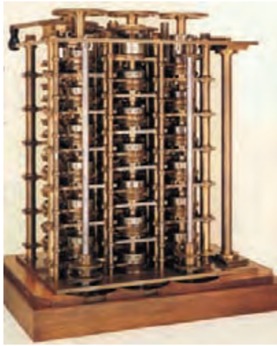
Fig. 3 La sezione di calcolo della prima Macchina delle Differenze, assemblata nel 1822 (altezza 72 cm). La sezione di stampa è andata perduta.
