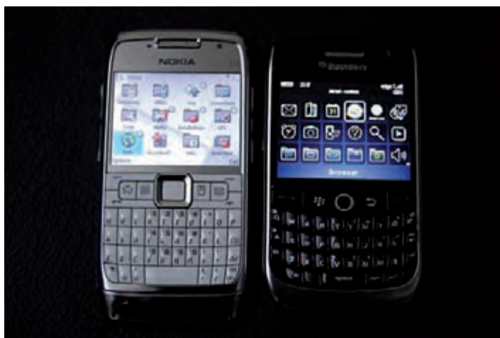
Fig. 7 Due modelli di smartphone con tastiera da macchina da scrivere (QWERTY), consentono di telefonare, mandare e ricevere messaggi, scattare fotografie e inviare immagini, connettersi a internet, organizzare l'agenda, riprodurre musica e archiviare qualsiasi tipo di informazione e tante altre funzioni ancora.
