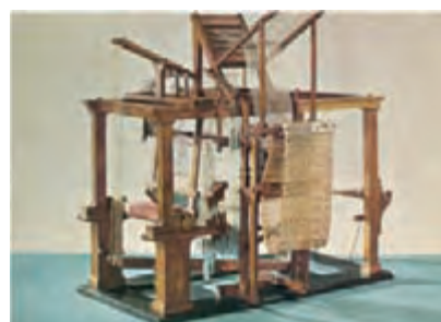
Fig. 7 Telaio semiautomatico Jacquard. In primo piano risaltano le schede perforate che “programmano” il disegno della trama, concatenate tra loro e trascinate da un rullo a sezione prismatica.
