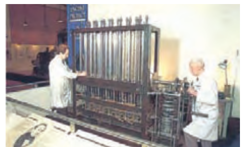
Fig. 4 La sezione di calcolo della Macchina delle Differenze n. 2, costruita negli anni Novanta (bicentenario della nascita di Babbage) presso lo Science Museum di Londra. Pesa più di 3 tonnellate e si compone di circa 4000 parti elementari. Opera su numeri di 30 cifre decimali, utilizzando le differenze fino al settimo ordine.
