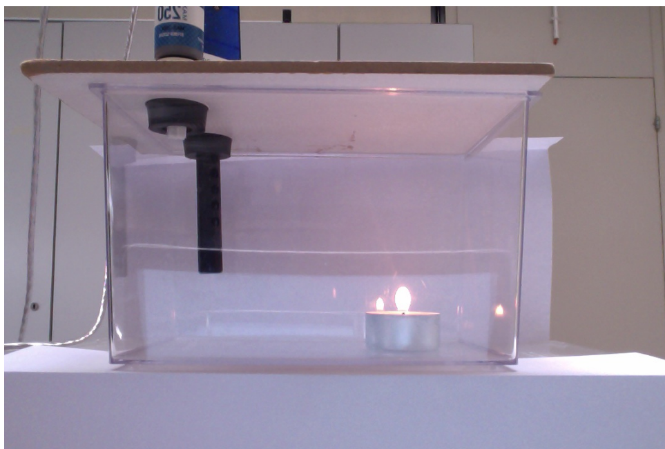
Figura 4: Dispositivo sperimentale. La candela accesa è posta sul fondo del recipiente. Nel coperchio sono inserite due sonde (collegate ad un computer non visibile nell'immagine) che misurano la concentrazione di diossigeno e di diossido di carbonio presenti nel recipiente.
