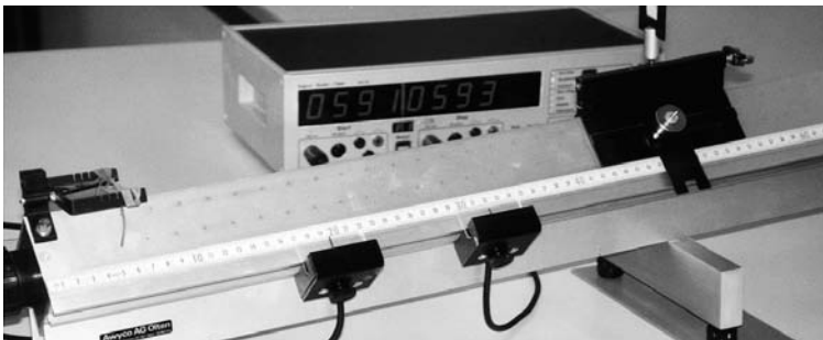
Fig. 1b Le fotocellule sono poste verso la fine del binario; la slitta ha raggiunto la velocità limite, come è possibile dedurre dai tempi di passaggio praticamente identici.
